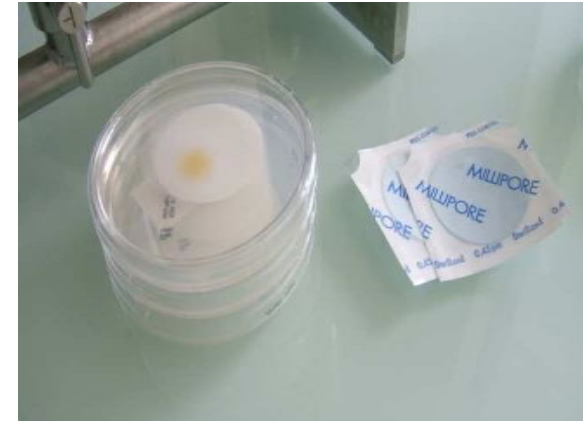
Filtre à 0,45 µm + Milieu de culture
